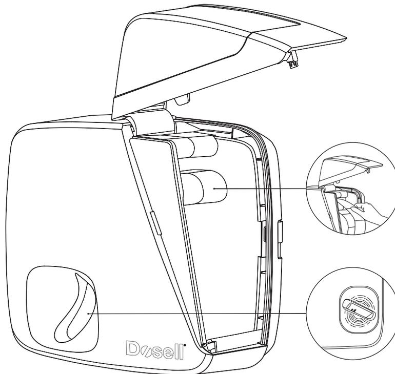
**No tire del rollo manualmente, el dispositivo lo extraerá automáticamente.**
